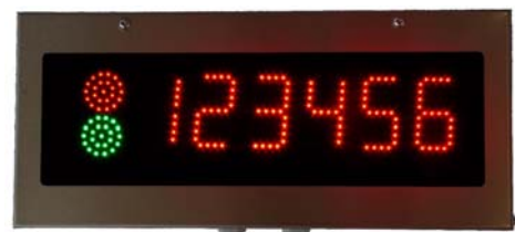
Bild: Fernanzeige DFA 67 mit Ampel (rot/grün)
